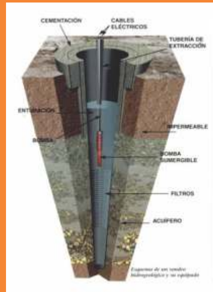
Figura 7. Partes del Pozo
