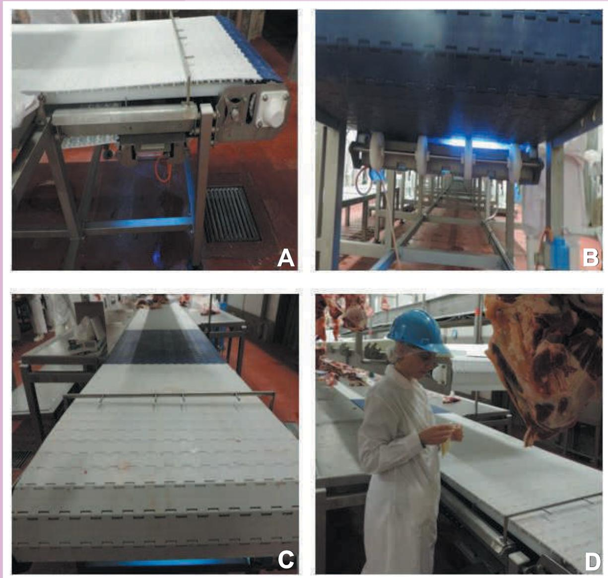
**Figura 1.** Sistema UV-C en planta frigorífica:
