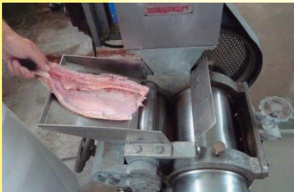
Figura 10. Proceso de despulpado.
