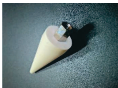
Figura 1.- Texturómetro y sonda utilizada para la determinación de la dureza de los oleogeles.
