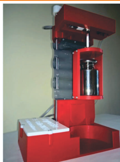
Figura 1.- Texturómetro y sonda utilizada para la determinación de la dureza de los oleogeles.
